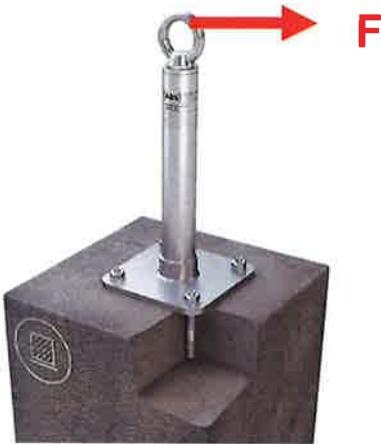
Prüfaufbau 1: ABS-Lock® X-SR-AS mit Position und Richtung der Krafteinleitung
