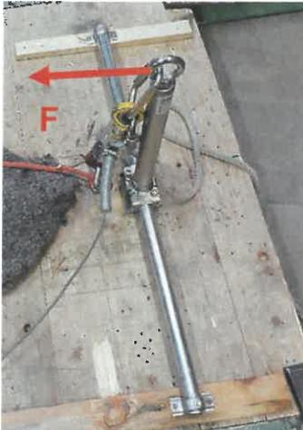
Prüfaufbau 1: Montierte Anschlagereinrichtung mit Position und Richtung der Krafteinleitung.
