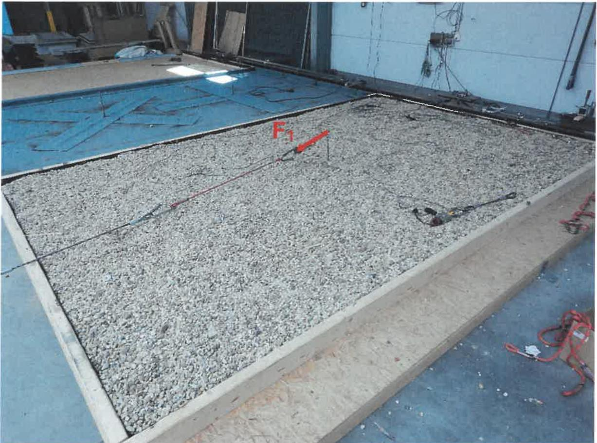
Prüfaufbau B: Anschlagereinrichtung, Typ: ABS-Lock OnTop montiert auf Bitumendachbahn ohne Attikaanschluss und Rundkiesabdeckung mit Höhe von 4cm - 5cm und errechneter Ballastierung von 1300kg laut Auftraggeber.
