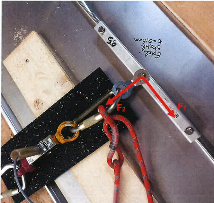
Prüfaufbau 11: Anschlagereinrichtung, Typ: ABS-Lock® Falz V montiert auf Doppelstehfalzdach (Edelstahl, t = 0,5 mm) mit Kräfteinwirkungsrichtungen F_1 und F_2
