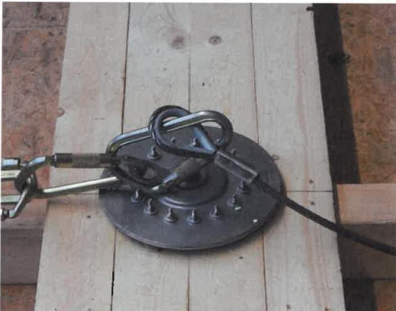
Bild 2, Anschlagereinrichtung, Typ: ABS-Lock® Falz-H, montiert auf einer starren Unterkonstruktion aus Holz
