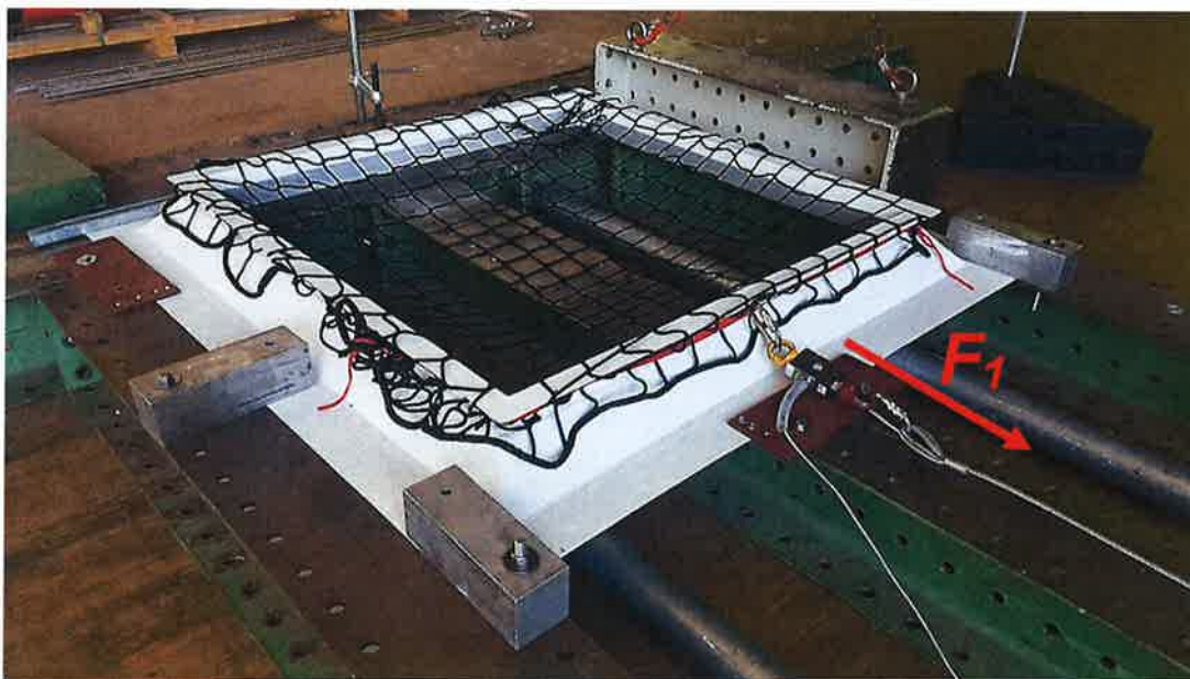
Bild 3: Prüfaufbau B zur Prüfung als Anschlagereinrichtung
