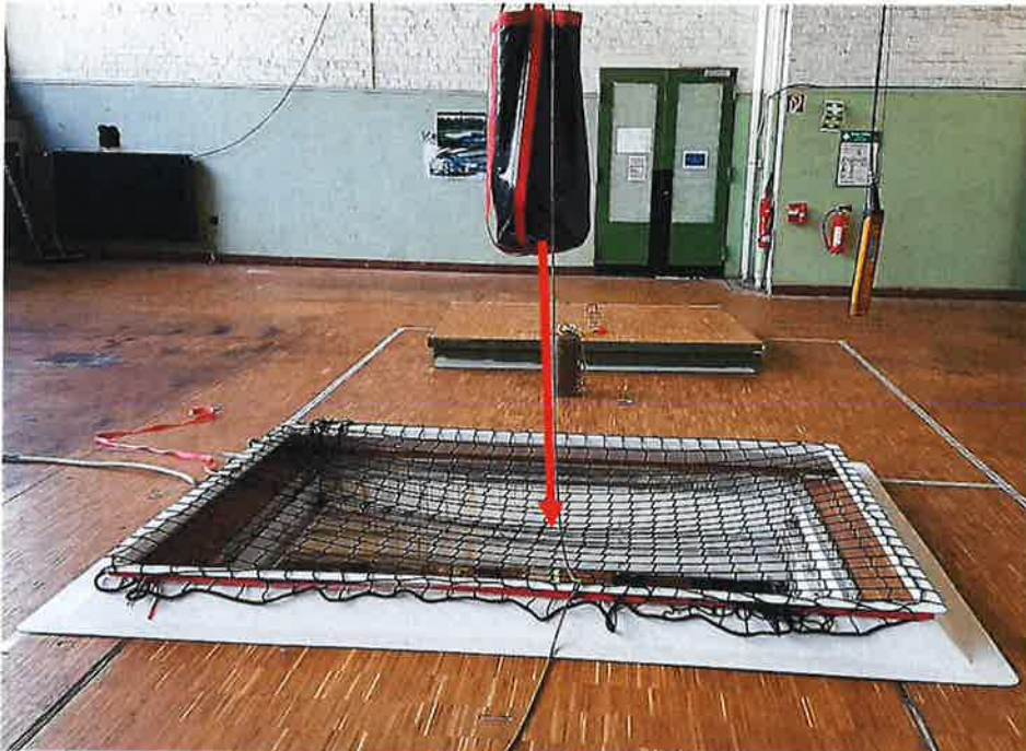
Bild 2: Prüfaufbau A zur Prüfung als Durchsturzsicherung
