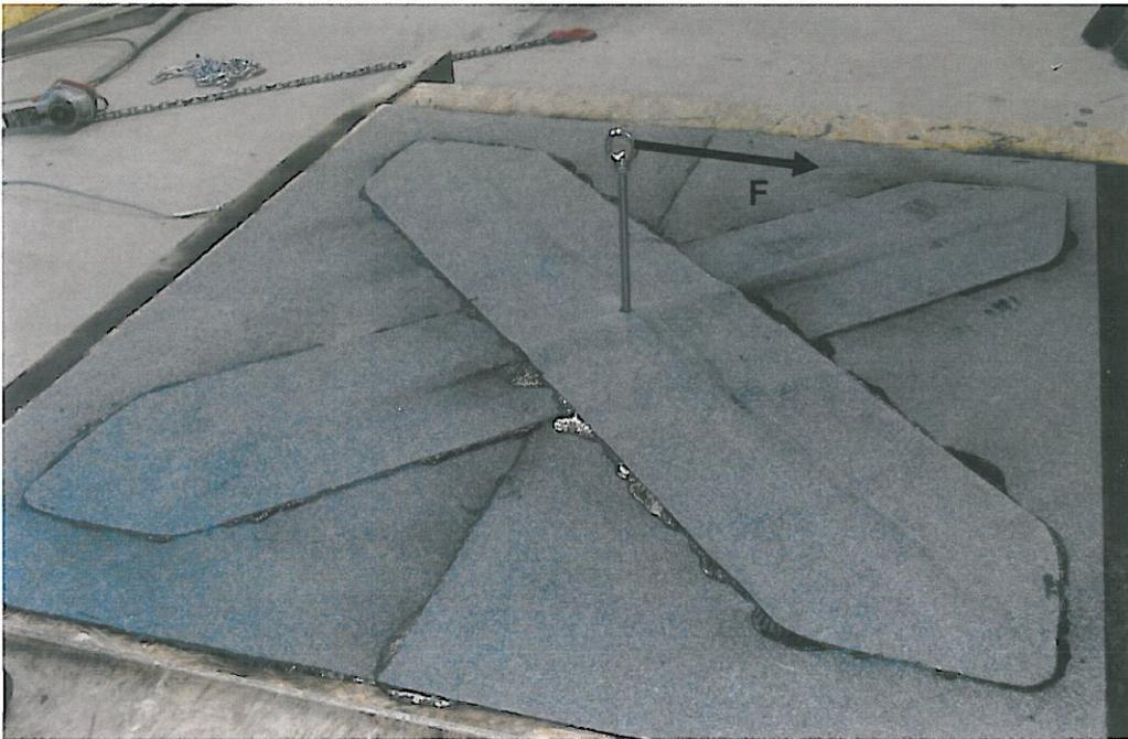
Bild 3: Prüfaufbau mit Richtung und Position der eingeleiteten Prüfkraft an der Anschlagereinrichtung Typ: ABS-Lock OnTop (hier Bitumen)
